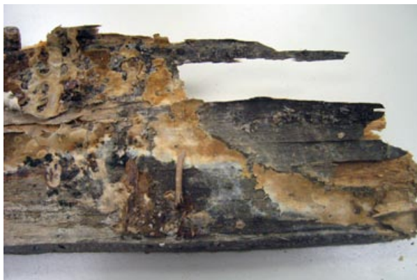
■ Slika 1. Les, preraščen z micelijem kletne gobe
