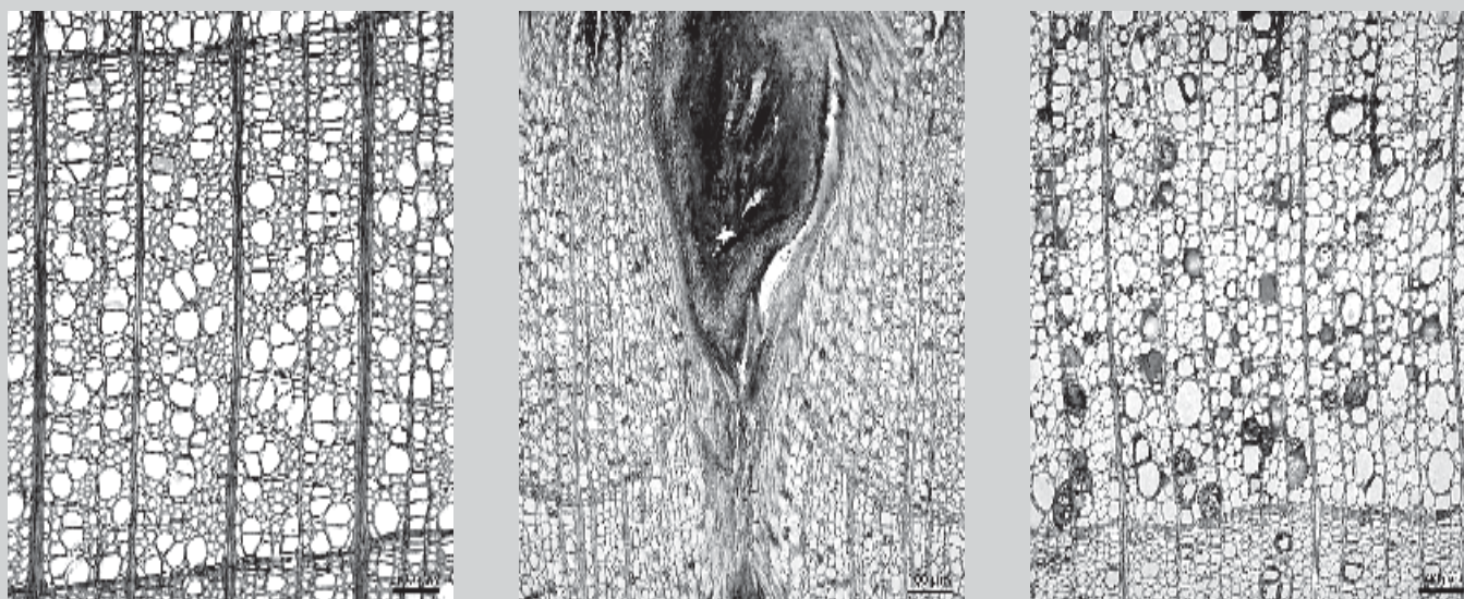
□ Slika 3. Lipa ( Tilia sp.), prečni prerez: (a) normalna zgradba lesa, (b) vključena skorja, (c) reakcijska cona
