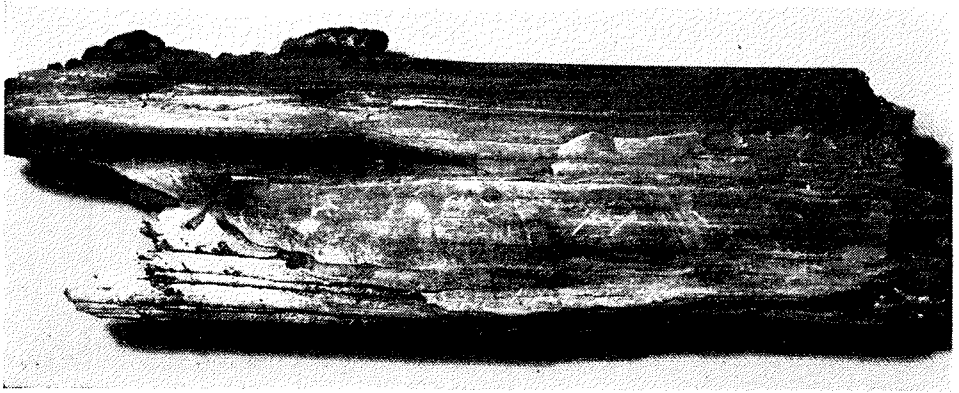
Sl. 26. Listasta (lamelasta) trohnoaba lesa, ki jo povzroča gniloživka Gloeophyllum abietinum (Bull. ex. Fr.) P. Karst. v smrekovem, s katranskim oljem impregniranim električnem drogu, ki je bil v 110 kV daljnovodu (4) Laško—Trbovlje
