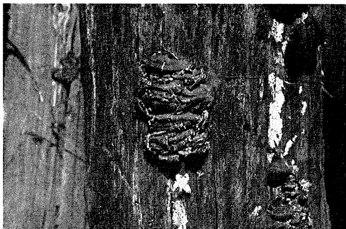
Sl. 14. Trosnjaki pisanke ( Trametes versicolor [L. ex Fr.] Pil.) na neimpregniranem hrastovem električnem drogu, ki je bil v 35 kV daljnovedu Ptuj—Ormož—Ljutomer—Murska Sobota.
