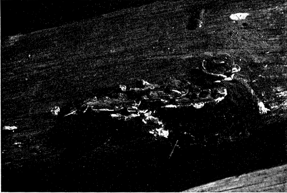
Sl. 9. Trosnjaki Trametes hirsuta (Wulf. ex Fr.) Pil. na izločenem hrastovem neimpregniranem električnem drogu na skladišču v Ptujju
