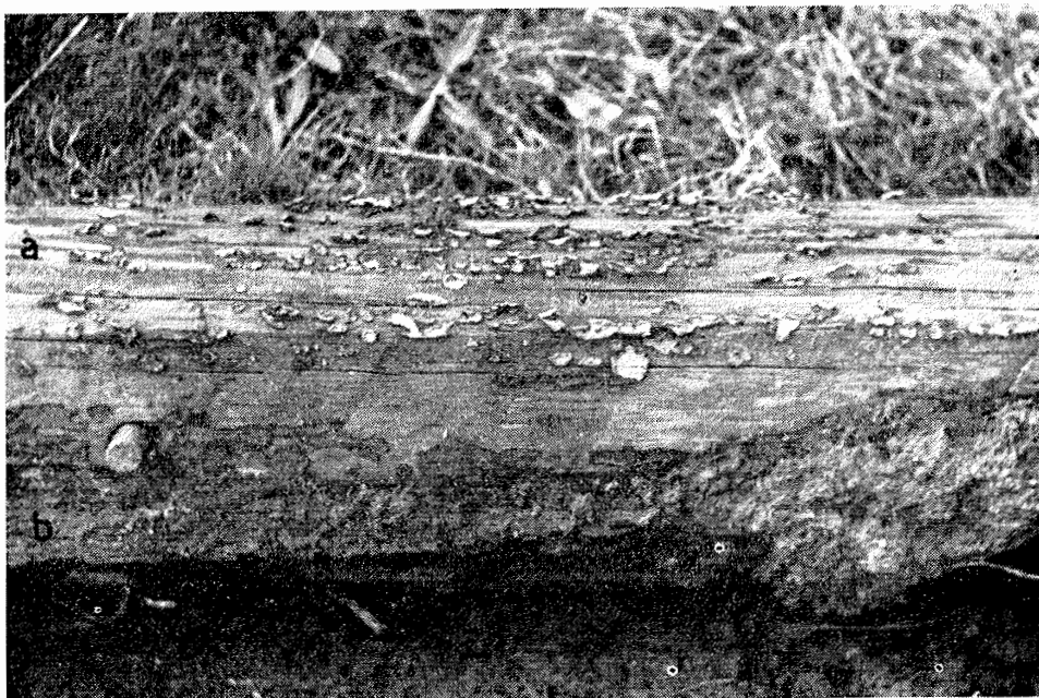
Sl. 4. Trosnjaki gliv Stereum hirsutum (Willd. ex Fr.) S. F. Gray (a) in Hymenochaete rubiginosa (Dicks. ex Fr.) Lév. (b) na električnem drogu iz domačega kostanja. Električni drog je bil v 110 kV daljnovodu Brestanica—Rakitje—Zagreb
