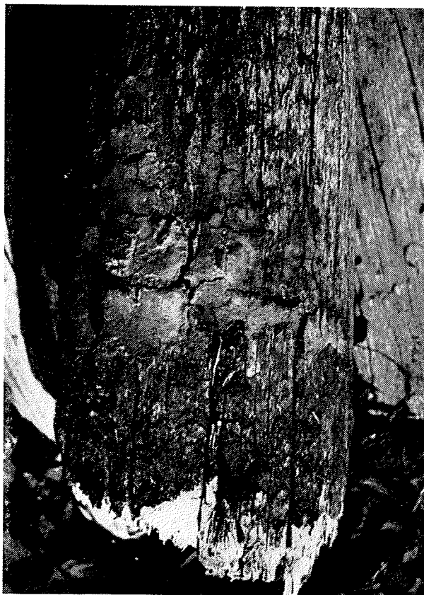
Sl. 29. Resupinatni tip trosnjakov glive Phellinus ferruginosus (Schrader ex Fr.) Bourd. et Galz na izločenem neimpregniranem hrastovem električnem drogu na skladišču v Ptuj
