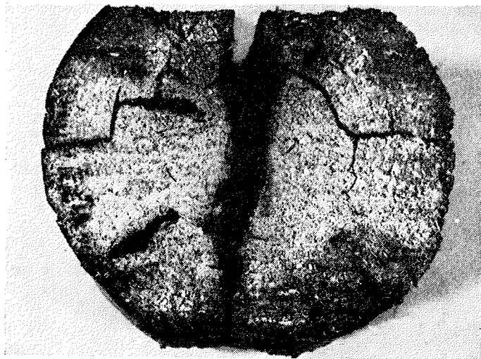
Sl. 17. Rjava, karbonizirajoča trohnoba lesa, ki jo povzroča gliva Coriolellus serialis (Fr.) Murr. v smrekovem, s katranskim oljem impregniranim električnem drogu. Ta je bil izločen iz 20 kV daljnovođa v okolici Vidma-Krškega
