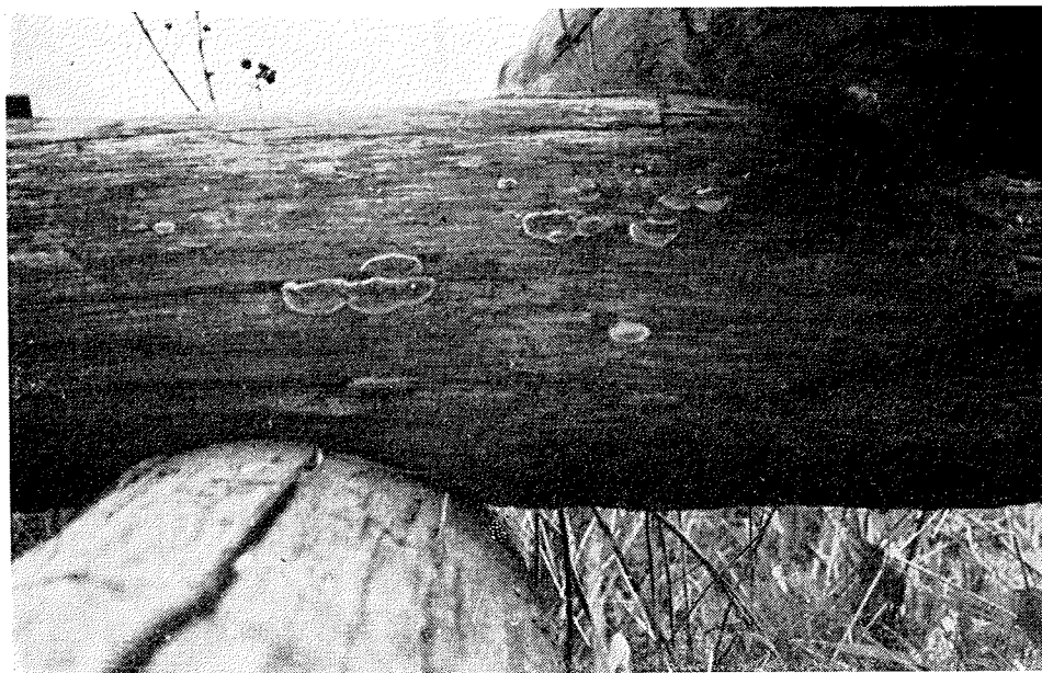
Sl. 11. Trosnjaki glive Trametes zonata (Nees ex Fr.) Pil. na neimpregniranem drogu iz domačega kostanja na skladišču v Vidmu-Krškem, izločenem iz električnega omrežja
